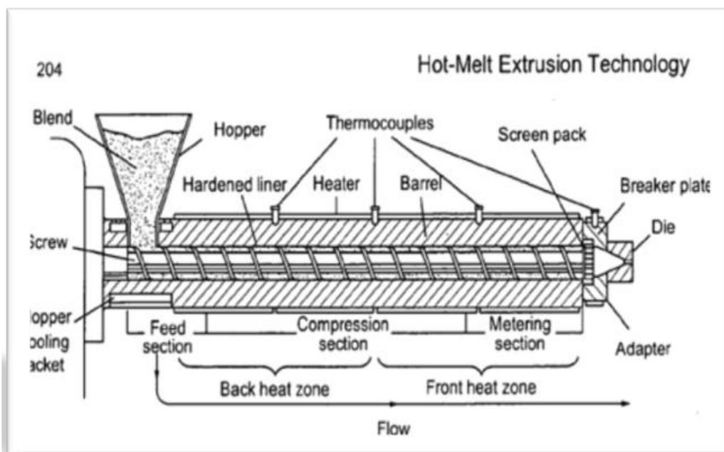
**Fig. 2: Hot Melt Extrusion Method.**
