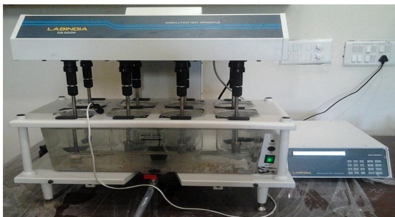
Fig. 5: Dissolution test apparatus.
